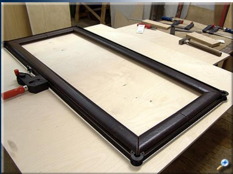
Центральные детали рамы можно отложить в сторону, а детали предназначенные для поворотных боковин, склеить на углах.
