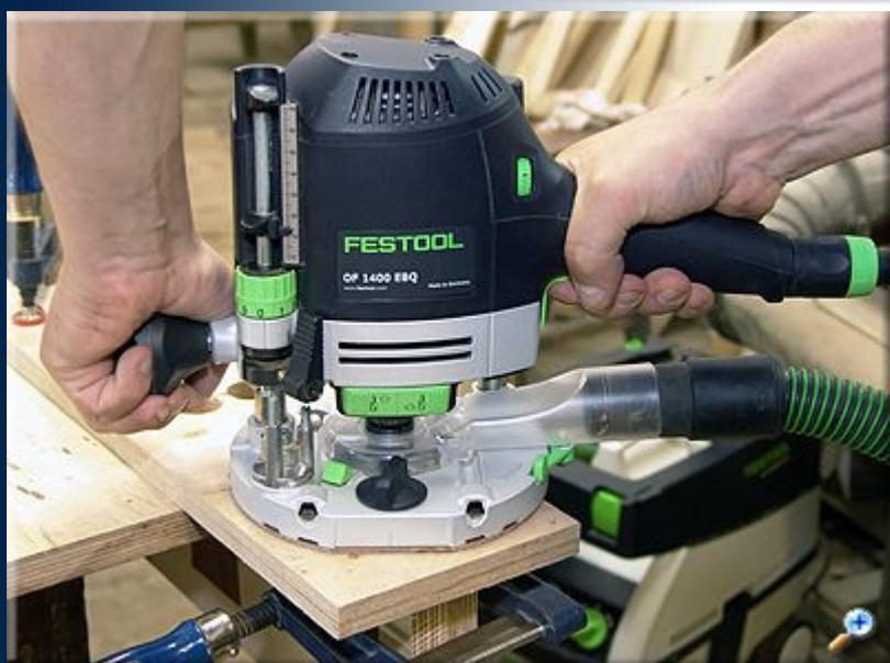
В данном случае, ручной фрезер выполняет функцию сверлильного приспособления. Копировальное кольцо фиксирует фрезер в необходимом положении, а ограничитель глубины фрезерования обеспечивает точное сверление отверстий на заданную глубину.
