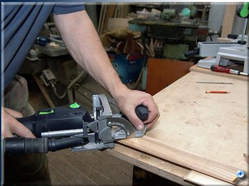
Так как детали после фрезеровки не имеют большой плоской поверхности, то при работе (под провисающий край платформы фрезера «Domino») необходимо подложить обрезок профиля, оставшийся после торцовки заготовок.
