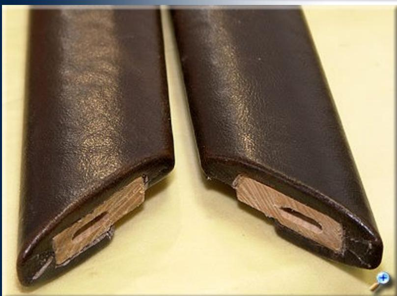
На скошенных под углом 45° торцах заворачиваем и подрезаем кожу таким образом, чтобы она не выходила за пределы наших пропилов.
