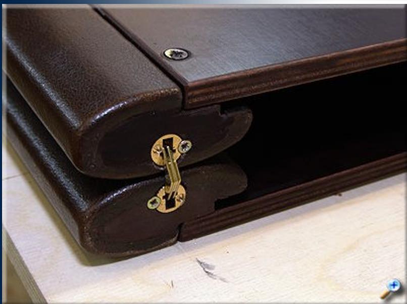
Поочередно накладываем поворотные боковины и надвигаем на вторую часть петли. Фиксируем шурупами.
