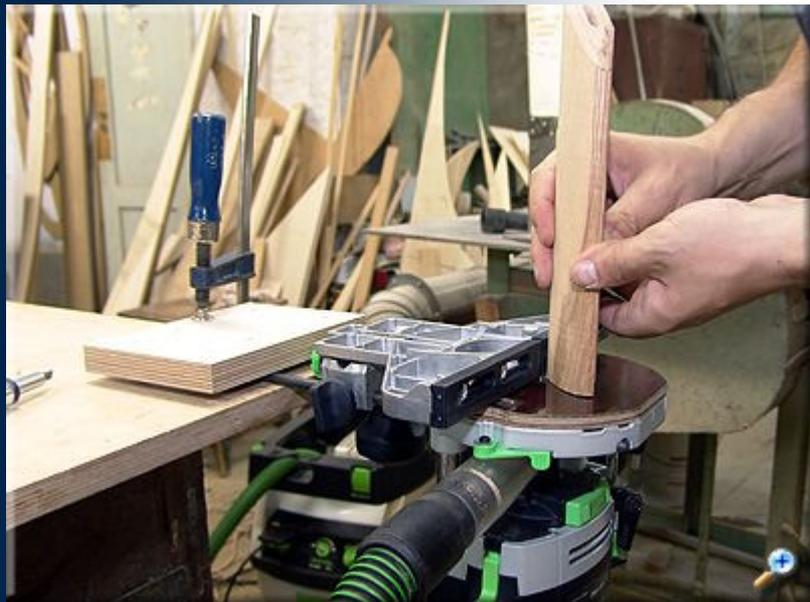
На этом работа с углами закончена. Теперь займемся поворотными боковинами. Для этого верхний и нижний бруски рамы разрежем на три части. Ширина средней части разрезанного бруска соответствует ширине центрального зеркала.
