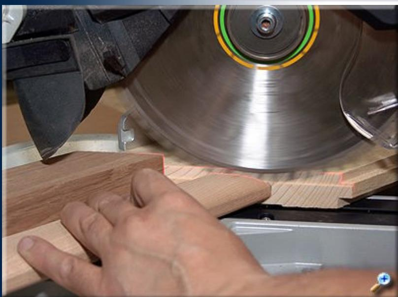
Изготовленное из брусков приспособление (ограничитель), позволит сделать небольшие пропилы в торцах наших деталей. Используя функцию плавного ограничения глубины торцевания, выставляем необходимый размер.
