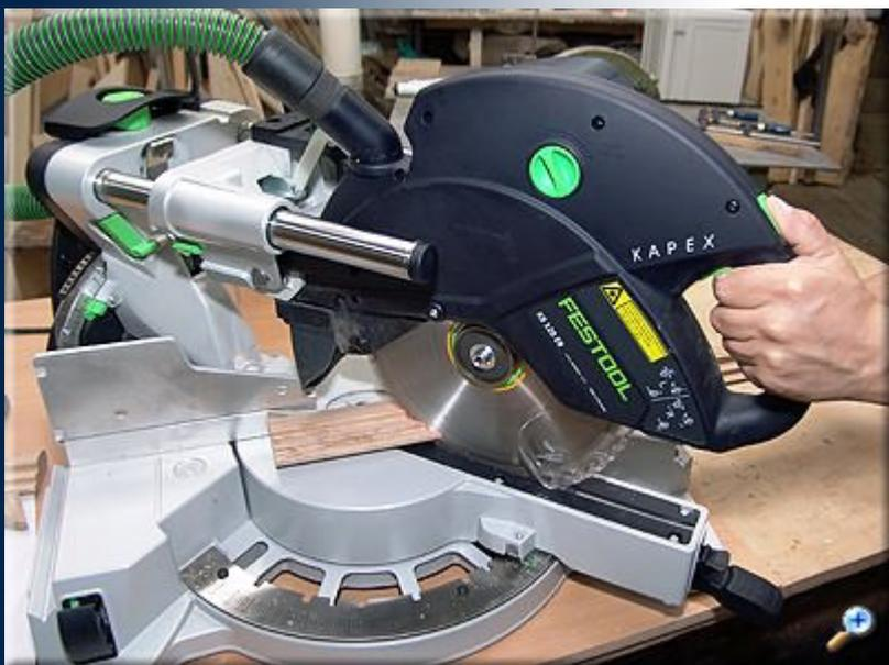
Теперь можно торцевать заготовки по длине. Вертикальные части рамы (боковины) торцуем в заданный размер, а горизонтальные (верх и низ) с припуском в две толщины пильного диска. Это необходимо учесть, так как позже мы будем резать эти детали на три части, формируя поворотные боковины зеркала.
