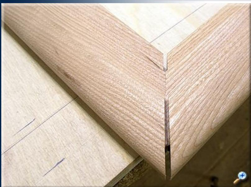
В собранном состоянии, внутренние части торцов плотно прилегают друг к другу. Внешние, наоборот, образуют щель, в которую и будут заворачиваться края кожи.
