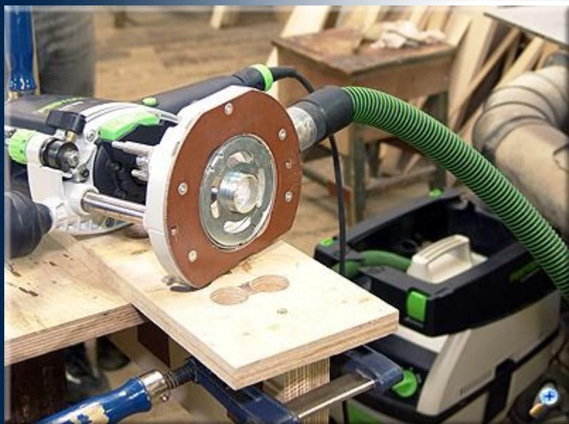
На поворотных боковинах рамы будем использовать петли для скрытого монтажа. Соответственно необходимо проделать в торцах деталей отверстия под петли. Для этого используем Т-образное приспособление с двумя отверстиями  $\varnothing 30$  мм, под копировальное кольцо.
