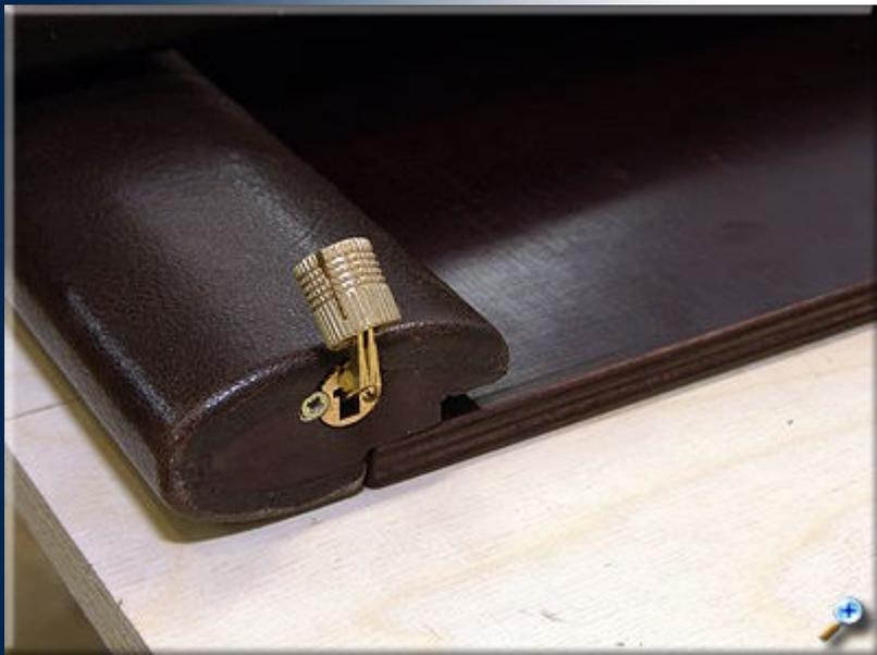
В подготовленные отверстия центральной части вставляем и закрепляем петли.
