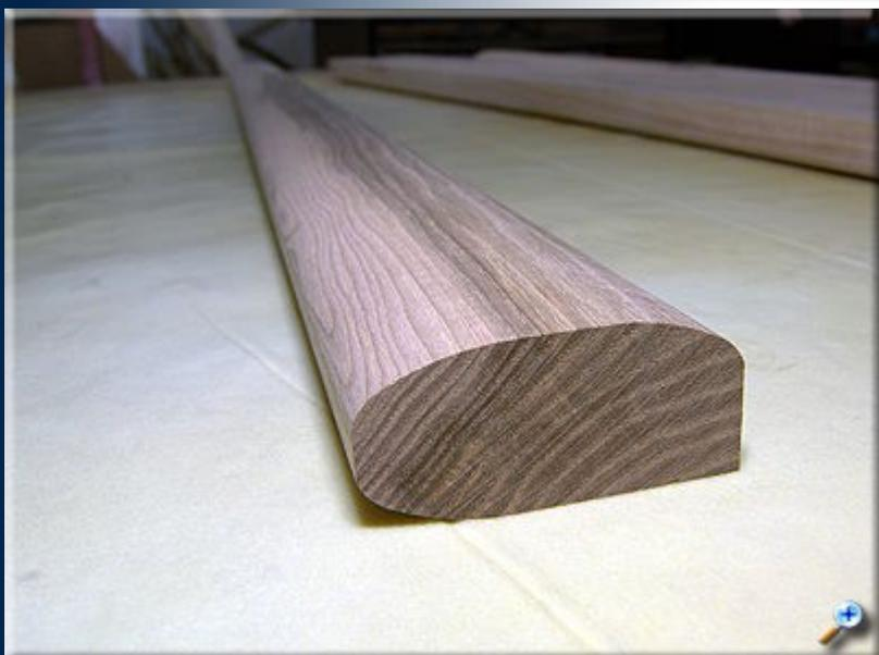
Для изготовления рамы необходимо 4 бруска, длина первых двух немного больше высоты рамы, а длина двух других, немного больше ее ширины. Заготовленные бруски обрабатываем по трем, граням, как показано на фотографии. На оставшейся грани будет двойная четверть для крепления зеркала и задней стенки.
