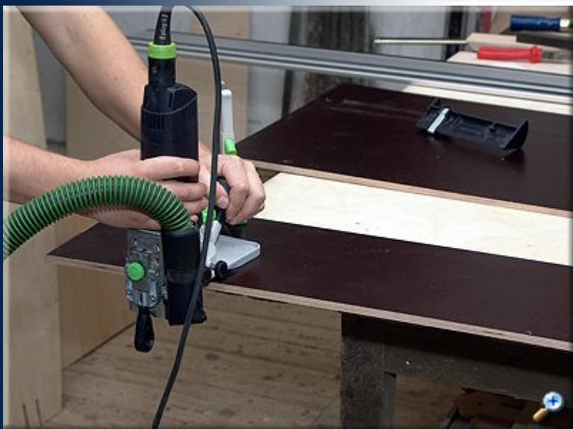
Обработывая кромки, снимаем небольшие радиусные фаски.
