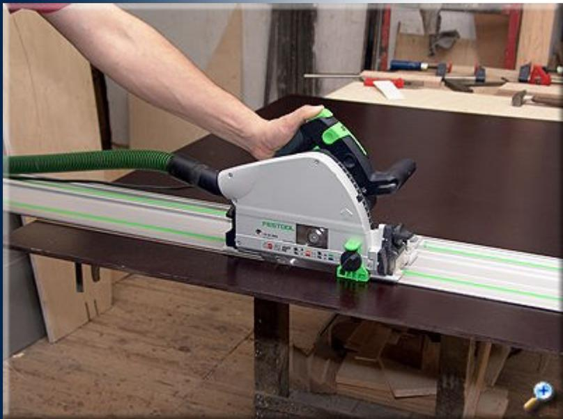
Пока клей затвердевает, займемся задней стенкой. В данном случае была использована фанера толщиной около 8мм с темным покрытием. Разрезаем фанеру по необходимым размерам.
