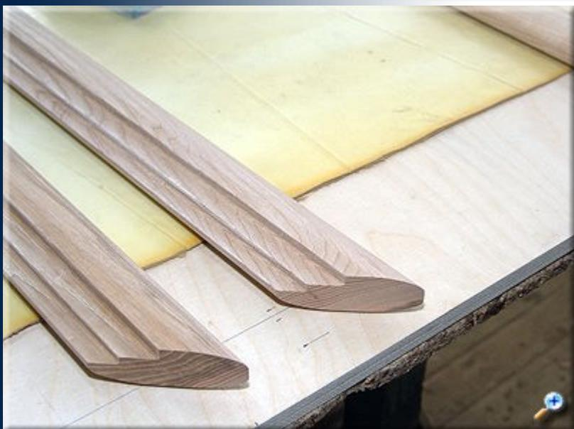
В итоге получаем четыре профилированных детали со скошенными под углом 45° торцами.
