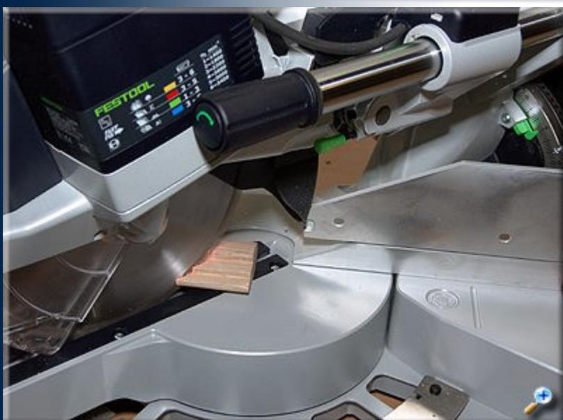
После окончания фрезеровки, один из торцов каждого бруска обрезаем под углом 45°.
