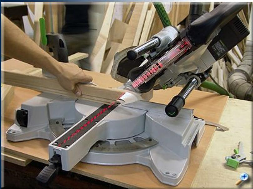
Далее наклоняем пильный диск на 45° и устанавливаем детали на ребро.
